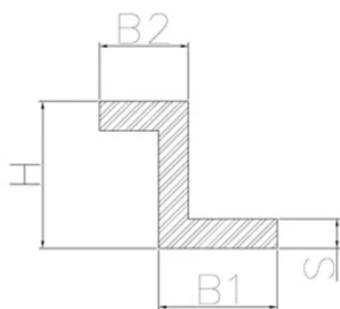
Les **profilés en Z** sont des extrudés réalisés avec les alliages d'aluminium **1050, 1070, 3103 et 6060** au format de barre ou bobine. Ils peuvent avoir des bases égales ou inégales et les tolérances dimensionnelles sont de **+/- 0,15 mm** sur le côté.
