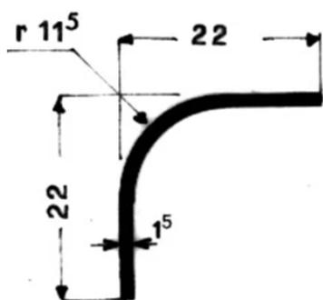
Les **pièces d'angle à section spéciale** sont des profilés particuliers réalisés avec l'alliage d'aluminium **6060** au format de barre. Les tolérances dimensionnelles sont de **+/- 0,15 mm** sur le côté.
