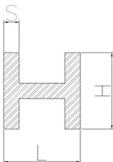
Les **profilés en H** sont des extrudés réalisés avec les alliages d'aluminium **1050, 1070, 3103 et 6060** au format de barre ou bobine. Ils peuvent avoir des côtés égaux ou inégaux et les tolérances dimensionnelles sont de **+/- 0,15 mm** sur le côté.
