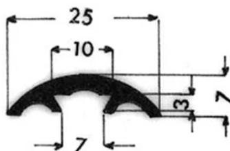
Les **bordures avec raccord vissé** sont des profilés particuliers réalisés avec l'alliage d'aluminium **6060** au format de barre. Les tolérances dimensionnelles sont de **+/- 0,15 mm** sur le côté.
