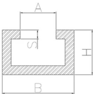
Les **profilés en C** sont des extrudés réalisés avec les alliages d'aluminium **1050, 1070, 3103 et 6060** au format de barre ou bobine. Les tolérances dimensionnelles sont de **+/- 0,15 mm** sur le côté.
