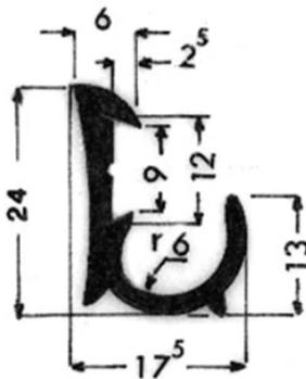
Les **égouttoirs et pare-eau** sont des profilés particuliers réalisés avec l'alliage d'aluminium **6060** au format de barre. Les tolérances dimensionnelles sont de **+/- 0,15 mm** sur le côté.
