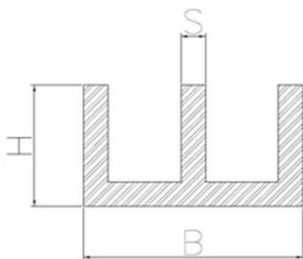
Les **conduits doubles** sont des profilés réalisés avec les alliages d'aluminium **1050, 1070, 3103 et 6060** au format de barre ou bobine. La taille va de **11 mm à 24,5 mm** et les tolérances dimensionnelles sont de **+/- 0,15 mm** sur le côté.
