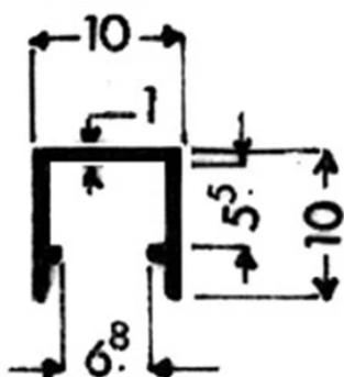
Les **profilés de blocage du verre** sont des extrudés particuliers réalisés avec l'alliage d'aluminium **6060** au format de barre. Les tolérances dimensionnelles sont de **+/- 0,15 mm** sur le côté.
