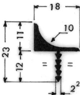
Les **poignées pour meubles** sont des profilés particuliers réalisés avec l'alliage d'aluminium **6060** au format de barre. Les tolérances dimensionnelles sont de **+/- 0,15 mm** sur le côté.
