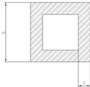
Les **tubes carrés** sont des profilés réalisés avec les alliages d'aluminium **1050, 1070, 3103 et 6060** au format de barre ou bobine. La taille minimum est de **8 mm** et les tolérances dimensionnelles sont de **+/- 0,15 mm** sur le côté.
