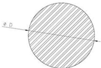
Les **barres rondes** sont des profilés réalisés avec les alliages d'aluminium **1050, 1070, 3103 et 6060** au format de barre ou bobine. La taille minimum est de **3,5 mm** et les tolérances dimensionnelles sont de **+/- 0,15 mm** de diamètre.
