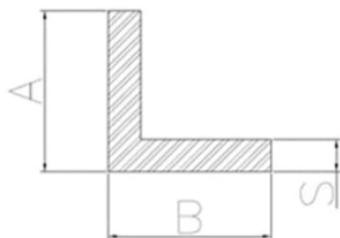
Les **cornières en aluminium** sont des profilés réalisés avec les alliages d'aluminium **1050, 1070, 3103 et 6060** au format de barre ou bobine. Les tolérances dimensionnelles sont de **+/- 0,15 mm** sur le côté.
