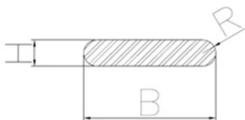
Les **barres plates à bords arrondis** sont des profilés réalisés avec les alliages d'aluminium **1050 et 1070** au format de barre ou bobine. La taille va de **12 mm à 120 mm** et les tolérances dimensionnelles sont de **+/- 0,15 mm** sur le côté.
