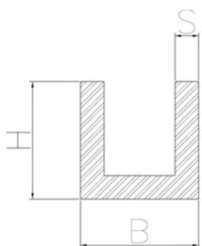
Les **profilés en U** sont des extrudés réalisés avec les alliages d'aluminium **1050, 1070, 3103 et 6060** au format de barre ou bobine. Les tolérances dimensionnelles sont de **+/- 0,15 mm** sur le côté.
