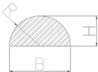
Les **profilés demi-ronds** sont des extrudés réalisés avec les alliages d'aluminium **1050, 1070, 3103 et 6060** au format de barre ou bobine. Les tolérances dimensionnelles sont de **+/- 0,15 mm** de diamètre.
