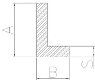
Les **profilés en alu en L** sont des extrudés réalisés avec les alliages d'aluminium **1050, 1070, 3103 et 6060** au format de barre ou bobine. Les tolérances dimensionnelles sont de **+/- 0,15 mm** sur le côté.
