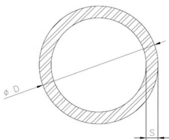
Les **tubes ronds** sont des profilés réalisés avec les alliages d'aluminium **1050, 1070, 3103 et 6060** au format de barre ou bobine. La taille minimum est de **5 mm** et les tolérances dimensionnelles sont de **+/- 0,15 mm** de diamètre.
