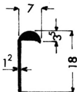
Les **barres angulaires en aluminium** sont des profilés particuliers réalisés avec l'alliage d'aluminium **6060** au format de barre. Les tolérances dimensionnelles sont de **+/- 0,15 mm** sur le côté.
