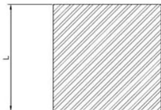
Les **barres carrées** sont des profilés réalisés avec les alliages d'aluminium **1050, 1070, 3103 et 6060** au format de barre ou bobine. La taille minimum est de **4 mm** et les tolérances dimensionnelles sont de **+/- 0,15 mm** sur le côté.
