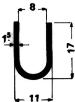
Les **profils spéciaux en U** sont des extrudés particuliers réalisés avec les alliages d'aluminium **1050, 1070, 3103 et 6060**. Les tolérances dimensionnelles sont de **+/- 0,15 mm** sur le côté.
