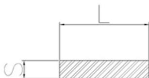
Les **barres plates** sont des profilés réalisés avec les alliages d'aluminium **1050, 1070, 3103 et 6060** au format de barre ou bobine. La taille va de **5 mm à 100 mm** et les tolérances dimensionnelles sont de **+/- 0,15 mm** sur le côté.
