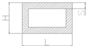
Les **tubes rectangulaires** sont des profilés réalisés avec les alliages d'aluminium **1050, 1070, 3103 et 6060** au format de barre ou bobine. La taille va de **12 mm à 80 mm** et les tolérances dimensionnelles sont de **+/- 0,15 mm** sur le côté.
